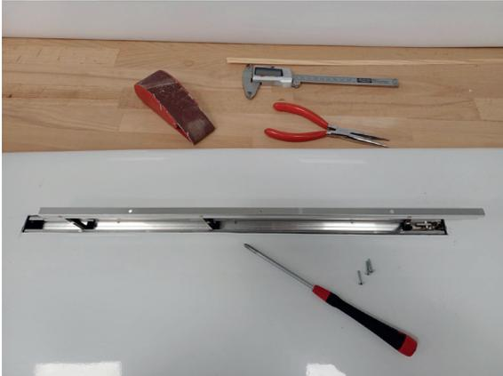
Verbinden Sie das Anschlußkabel der Störklappe mit dem empfohlenen Verlängerungskabel. Setzen Sie nun die Störklappe in den vorbereiteten Ausschnitt auf die Holzblöcke und fädeln das Kabel durch die Fläche.
