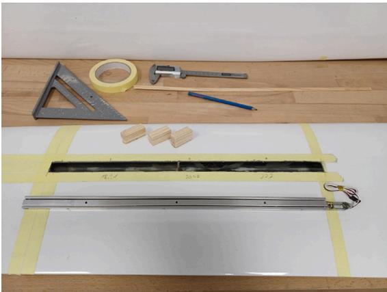
Platzieren Sie die Holzblöcke im Ausschnitt so, dass die Befestigungslöcher auf der Unterseite der Störklappe fluchten.
