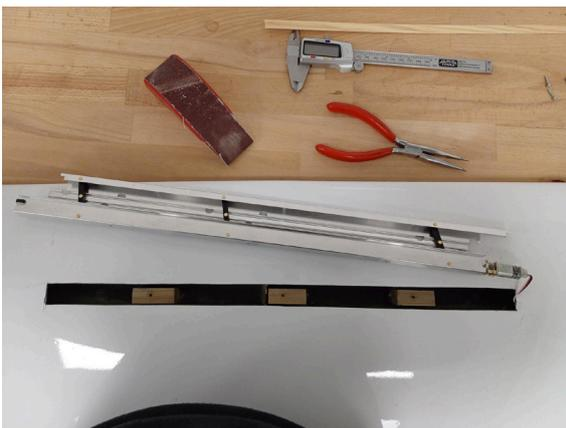
Nachdem die Positionen für die Holzblöcke ermittelt sind, werden die Holzblöcke mit geeignetem Klebstoff im Ausschnitt am Boden der Flächenunterseite eingeklebt.
