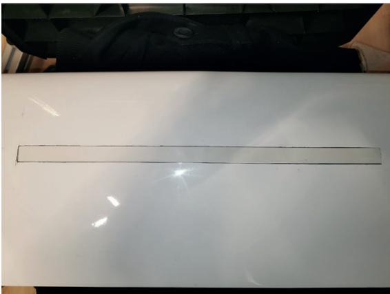
Fahren Sie die Störklappen wieder ein. Fertigen Sie aus einer 1mm starken weißen Kunststoffplatte eine passende Abdeckung welche den Ausschnitt abdeckt und passen diese so an, dass die Abdeckung nicht im Ausschnitt klemmt. Kleben Sie mit einem geeigneten Klebstoff die Abdeckung auf die Störklappe -
